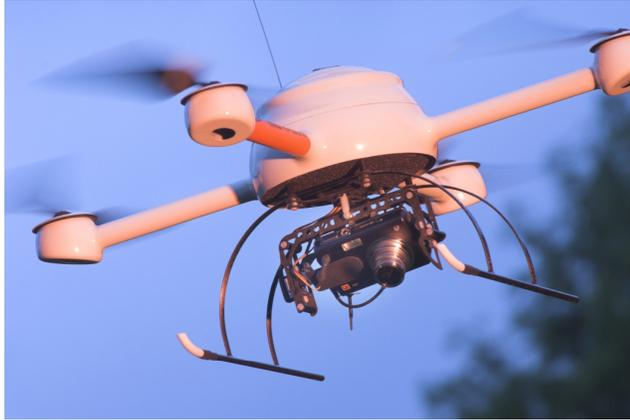
Abb.3: Microdrone ausgestattet mit Kamera
